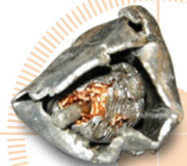
Kupferanker oder „Meatball“ aus einem Elektromotor
