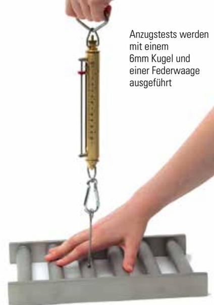
Anzugstests werden mit einem 6mm Kugel und einer Federwaage ausgeführt
